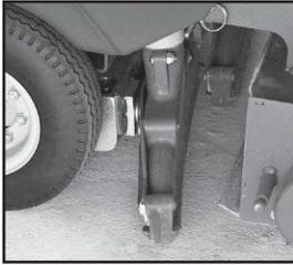
Las dos zapatas laminares de aspiración permiten una recuperación más eficiente de la solución.
