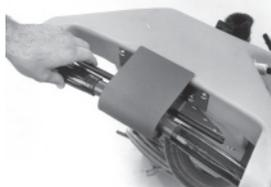
Los controles de fácil operación incluyen el encendido/apagado del cepillo con un apretón de la manija, interruptor del motor de aspiración, selector de varilla.
