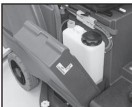
Con el sistema opcional EcoFlex, es posible tener una mayor flexibilidad y limpieza verde, gracias al tanque desmontable de gran capacidad que se puede adquirir.
