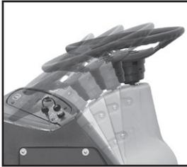
El diseño Clear View, permite ajustar la inclinación del compartimento, consiguiendo una conducción ergonómica y mejor visibilidad para los operadores.
